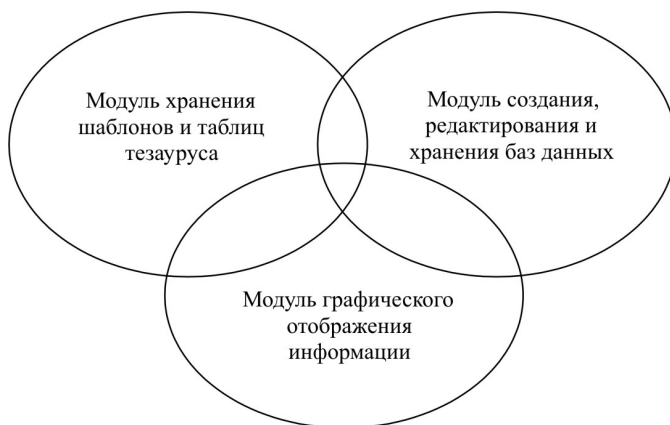
Рис. 1. Основные части архитектуры баз данных
