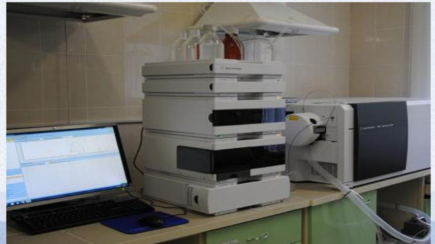
*Масс-спектрометр с индуктивно – связанной аргоновой плазмой (Agilent 7500cx)*
