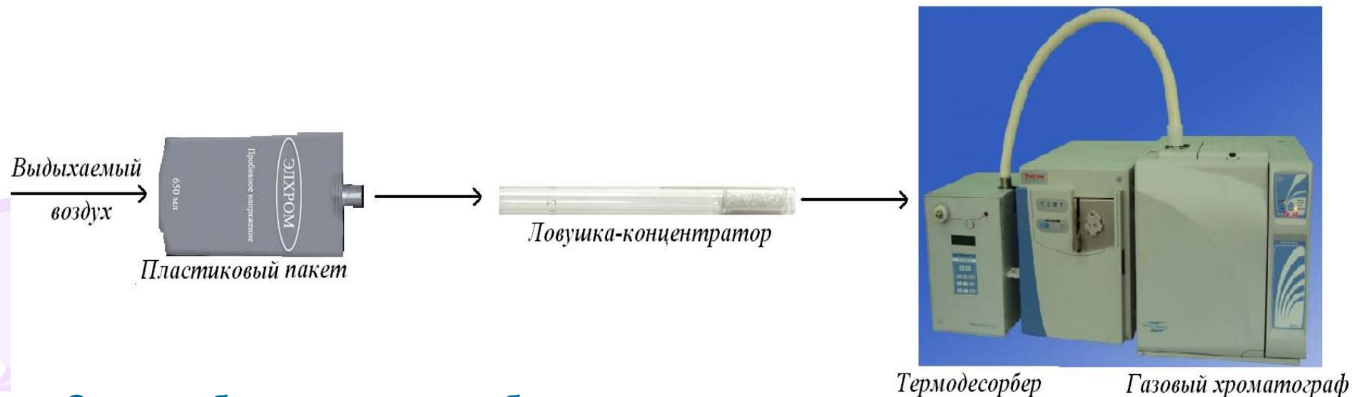
Схема отбора и анализ проб выдыхаемого воздуха
