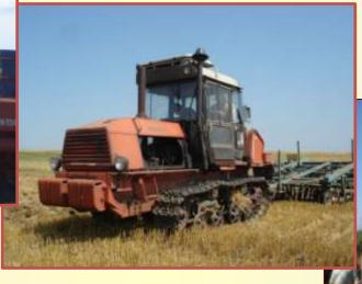
Кабины сварные, негерметичные, с нарушенной целостностью шумо- и виброизоляции
