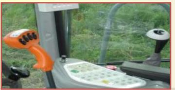
В результате эргономических усовершенствований органы управления находятся в пределах сенсомоторной зоны операторов (сгруппированы на рукоятке многофункционального манипулятора), что обеспечивает поддержание оператором удобной рабочей позы.
