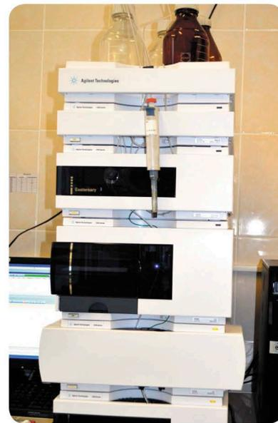
Жидкостный хроматограф Agilent 1200 с диодно-матричным детектором
