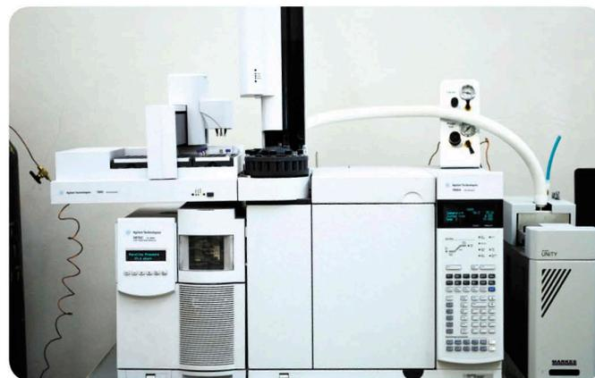
Газовый хроматограф с масс-спектрометрическим детектированием
