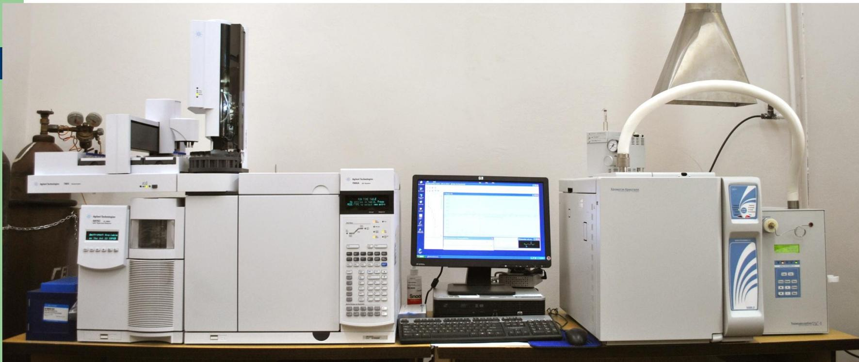
Идентификация выполнена при использовании системы газовая хроматография – масс-спектрометрия (ГХ-МС). Хроматографическое разделение проводили **на газовом хроматографе Agilent 7890A с использованием масс-селективного детектора 5975C и применением капиллярной колонки HP-5MS 30 m•0,250mm•0,25µm**. Поиск характеристических ионов метил-трет-бутилового эфира выполняли с помощью банка библиотеки масс-спектральных данных **NIST 08.L(Национальный институт стандартов США)**.
