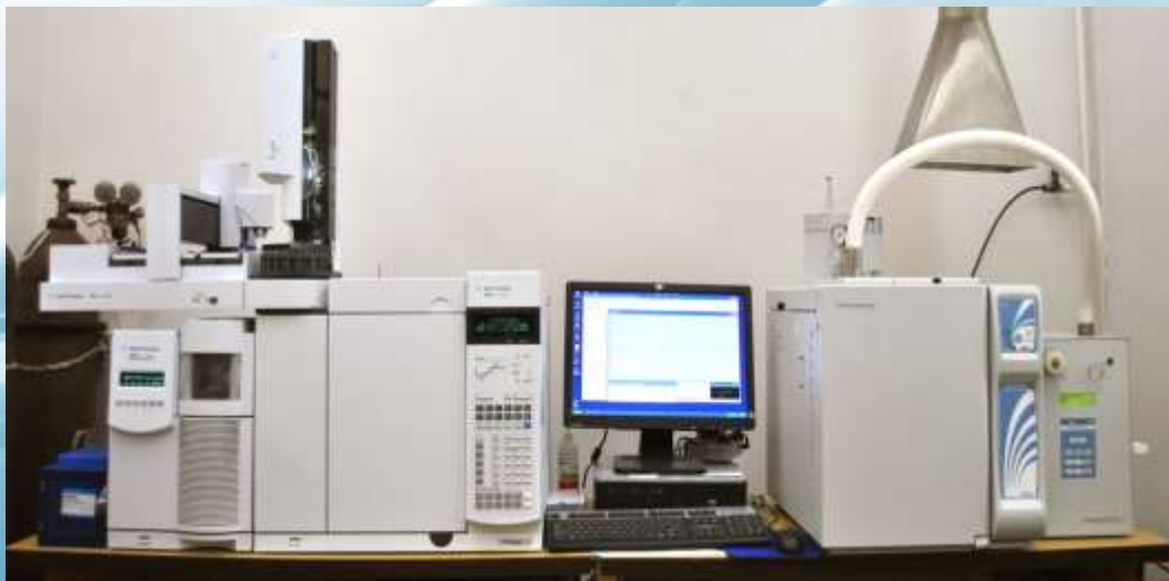
Газовый хроматограф Agilent 7890А с масс-селективным детектором
