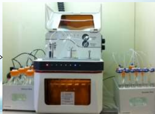
Пропускание дистиллята через картридж Coconut 6 с использованием системы ТФЭ
