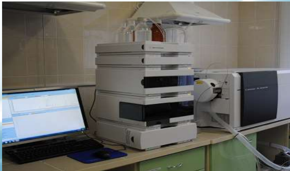
Жидкостный хроматограф Agilent 1200 с масс-спектрометрическим детектором
