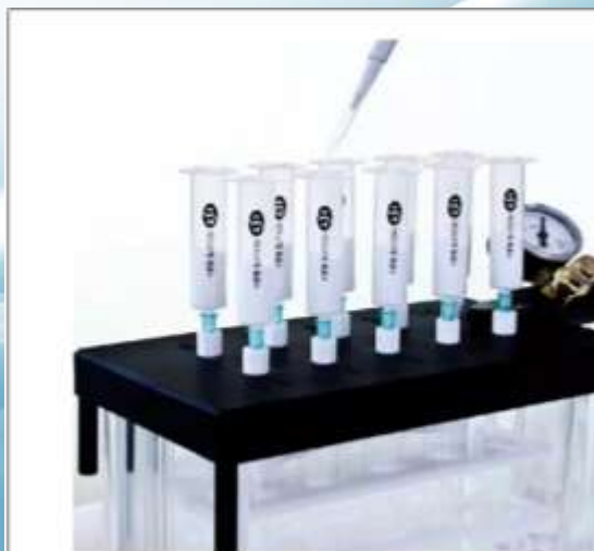
Штатив для пробирок и камера с вакуумным насосом для проведения твердофазной экстракции
